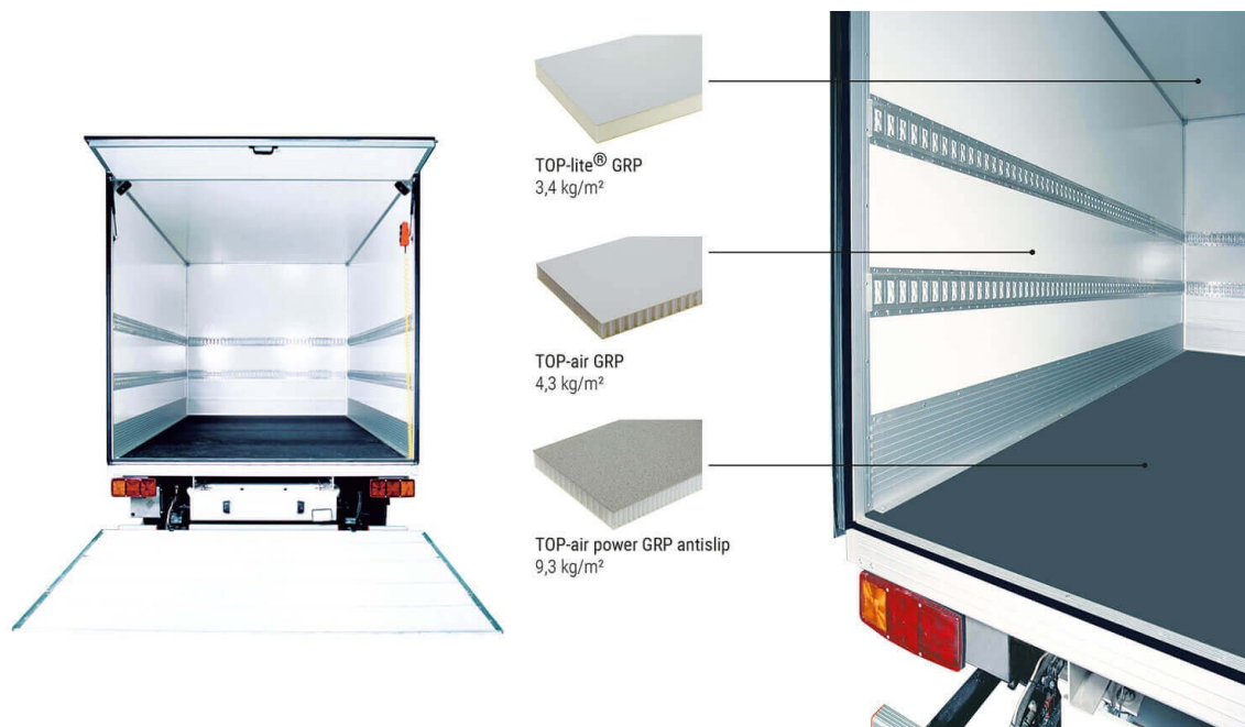
Obrázek 12 Sendvičové panely v nákladním prostoru užitkových automobilů [13]
