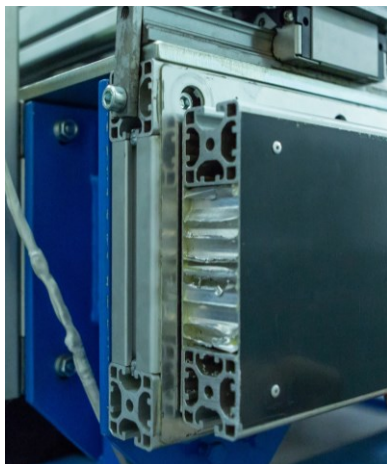
Obrázek 4 Sendvičový panel s voštinovým jádrem využívaný v dopravě [4]
