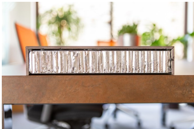
Obrázek 4 Sendvičový panel s voštinovým jádrem využívaný v dopravě [4]
