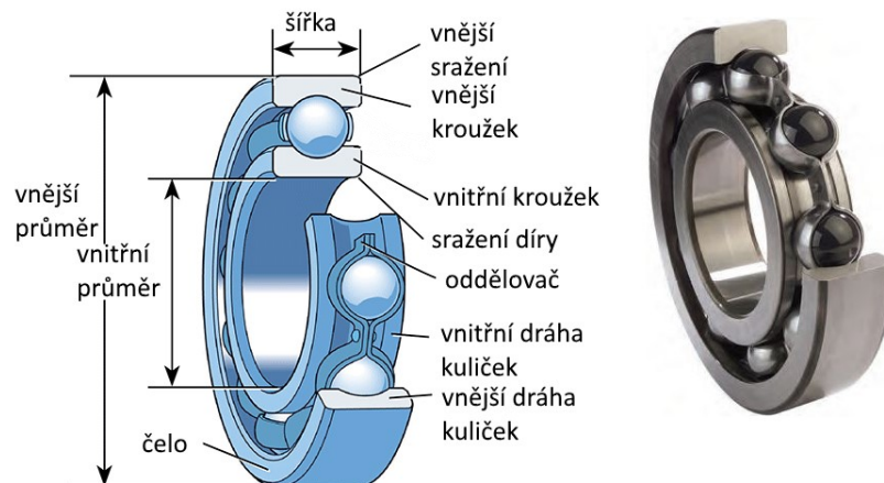
Obr. 28. Kuličkové ložisko [15]
