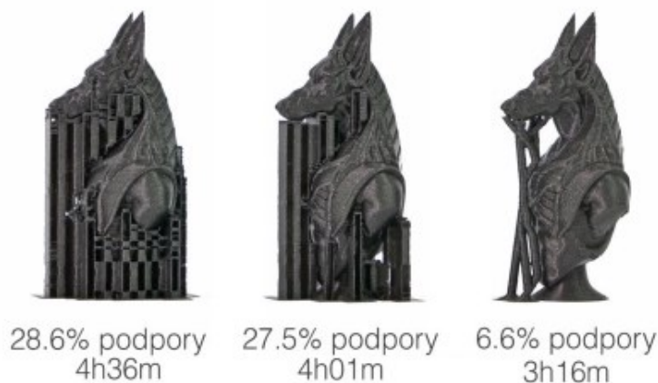
Obr. 27 - Mřížkové a stromové podpory, porovnání tiskového času [39]
