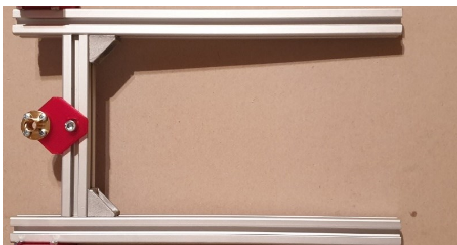
Obr. 58 - Konstrukce pro uchycení tiskové podložky s hybnou maticí
