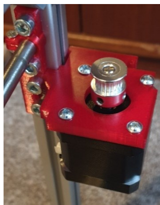
Obr. 70 - Krokový motor SX17 pro osu Y
