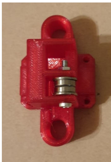
Obr. 62 - Pouzdro osy X s vodícími prvky
