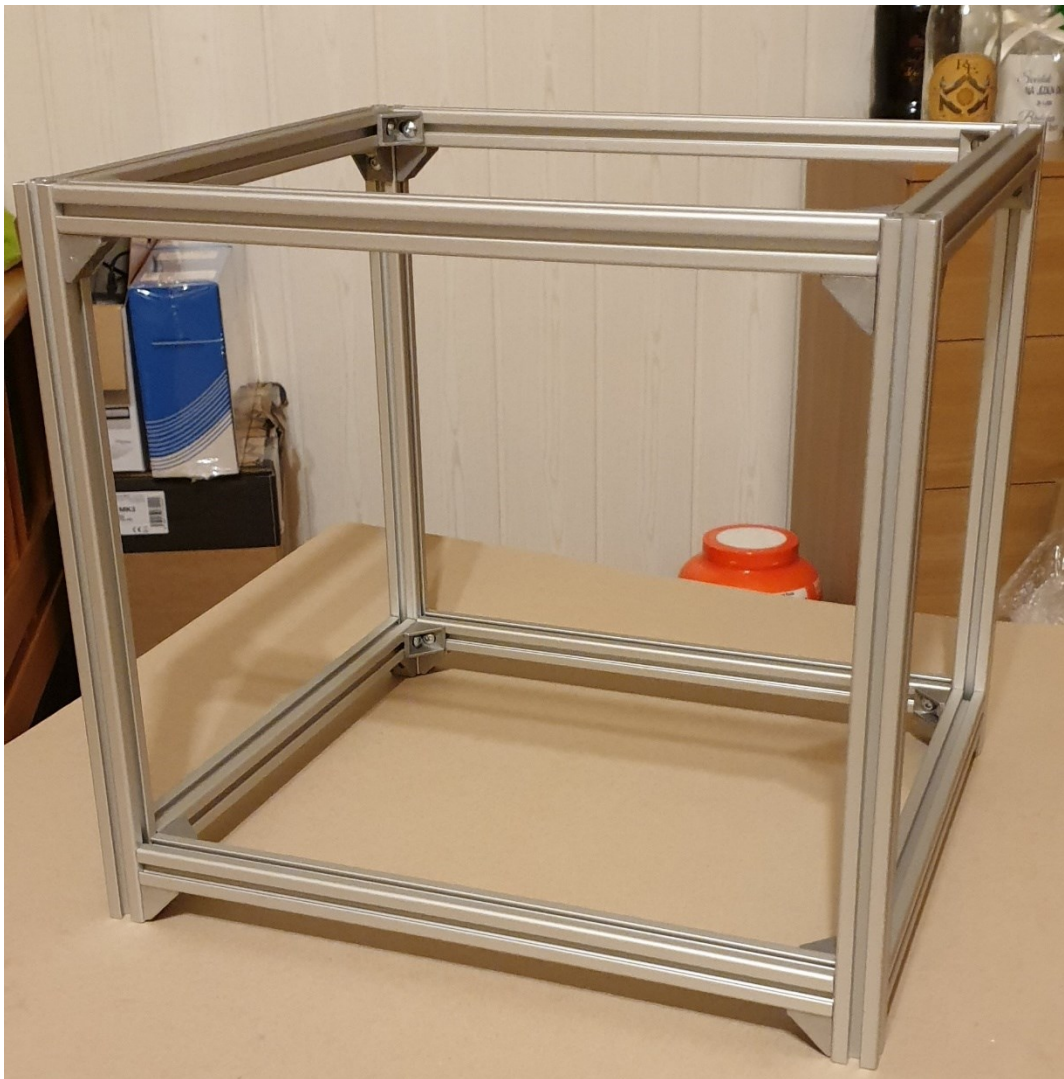
Obr. 53 - Samostatná konstrukce z profilů
