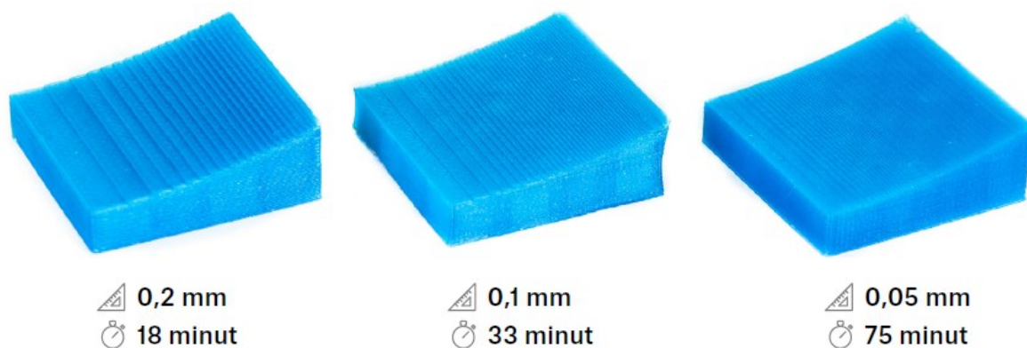
Obr. 24 - Rozdíl povrchu výtisku při různé výšce vrstvy [5]
