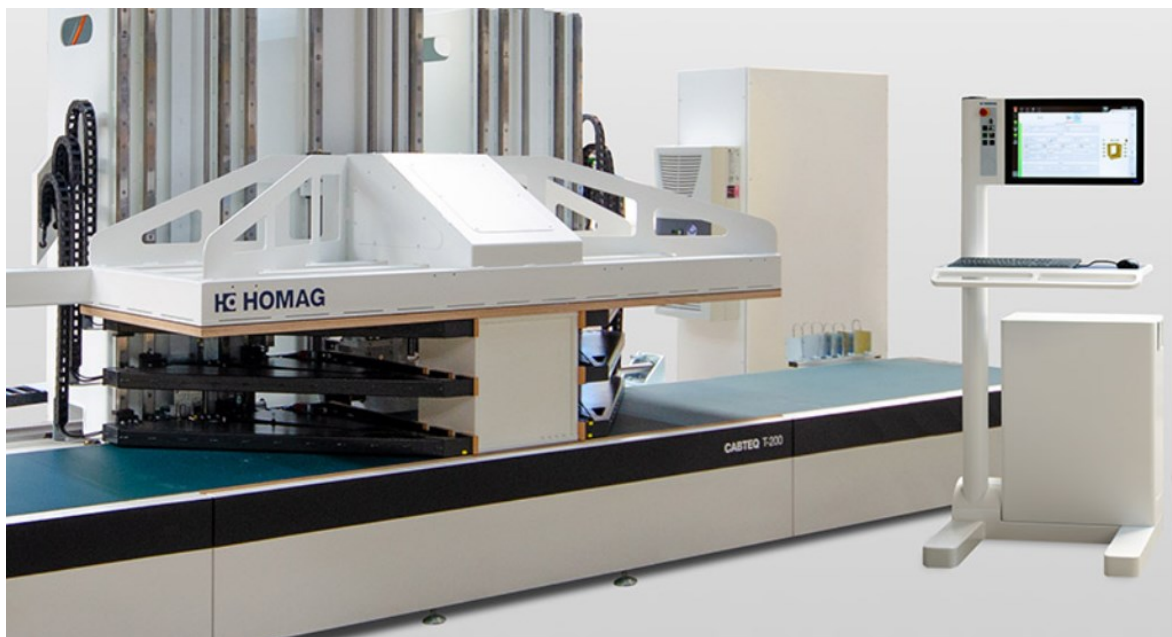
Obr. 11 Automatický průběžný korpusový lis Homag CABTEQ T-250 (foto epimex.cz)
