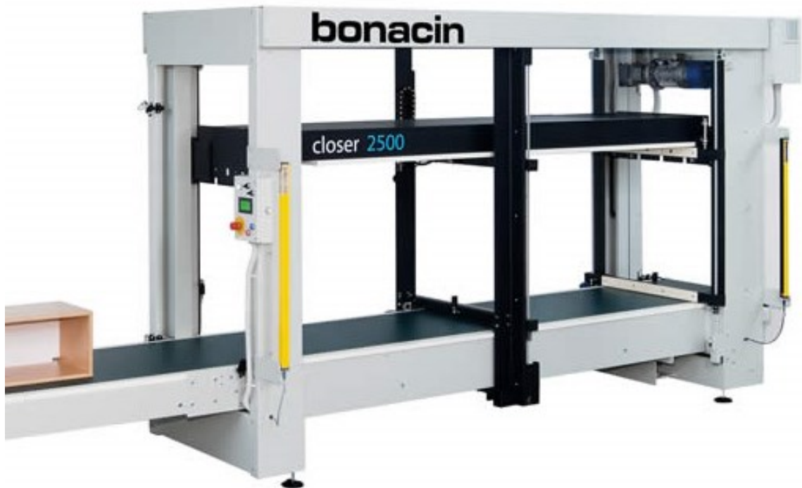
Obr. 12 Automatický průběžný korpusový lis Bonacin Closer 2500 (foto bonacin.it)
