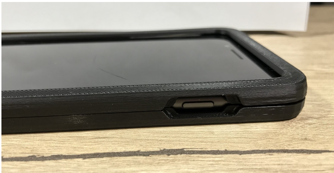
Obr. 37 Detail poslední verze ochranného rámečku (strana uzamykacího tlačítka)
