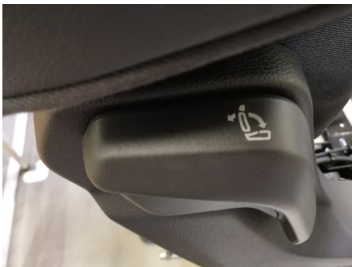
Obrázek 18 Páčka sklápania operadla Q7
