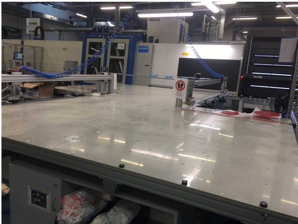
Obrázek 9 Stůl pro přesun sklad a osazení PMMA spaceru (vlastní zpracování)
