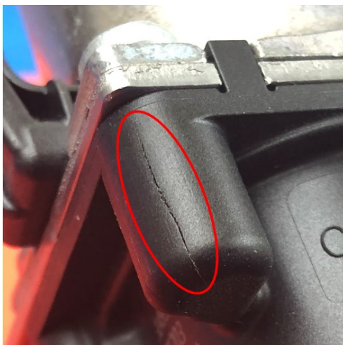
Obrázek 19 Vada prasklý domek (vlastní foto)
