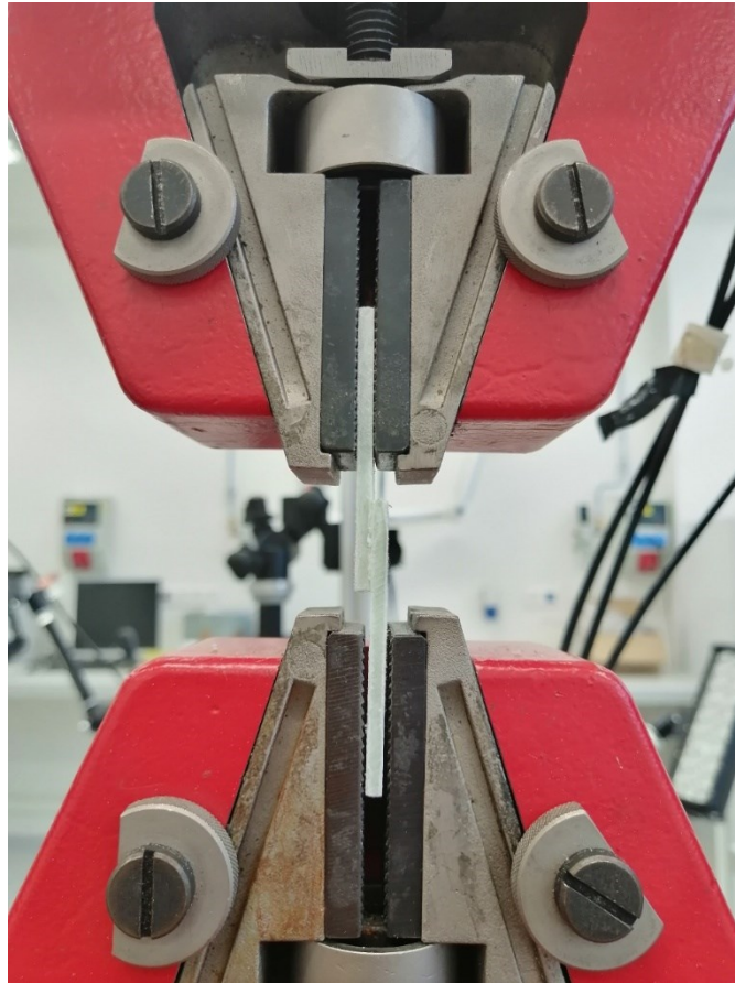
Obrázek 24: Uchycení vzorku mezi čelisti při tahové zkoušce.
