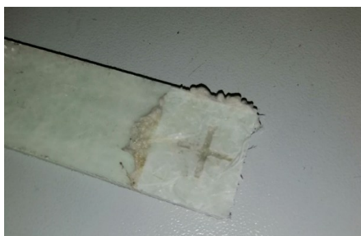
Obrázek 31: Vzorek s drážkou a přídatným plnivem po přetržení.
