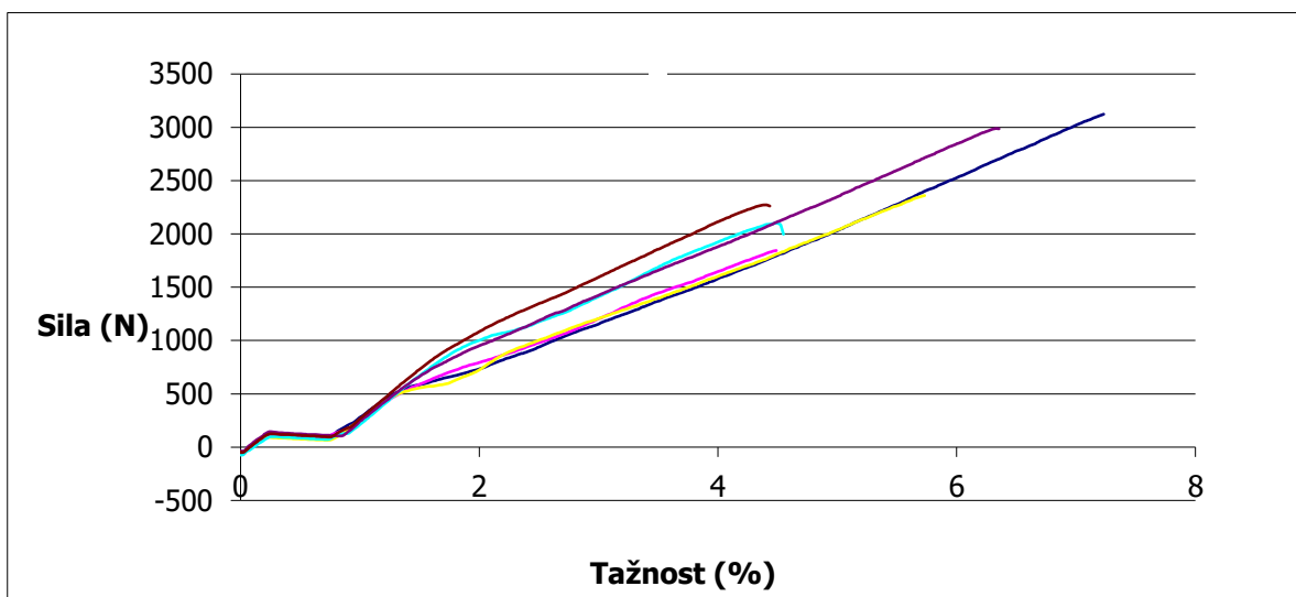
Graf 9: Závislost síly na tažnosti u vzorku F3. Vzorek s drážkou a s čistým akrylátu
