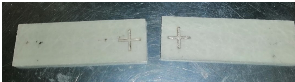
Obrázek 30: Křížová drážka vyrobená pomocí laseru
