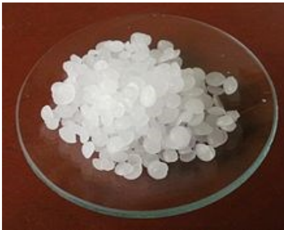
Obr. 24 Parafín, jádro mikrokapslí, směs pevných uhlovodíků řady C_nH_{2n+2} [58]
