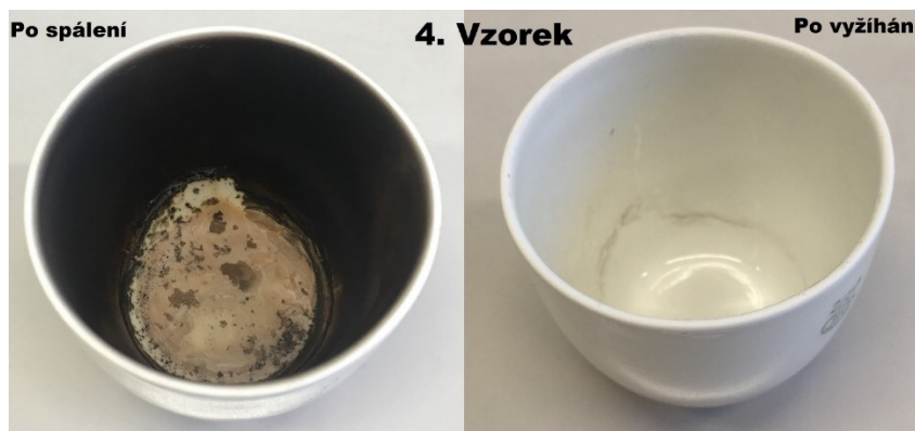
Obrázek 33: Vzorek č. 4 při stanovení popela - po spálení (vlevo) a po žihání (vpravo)
