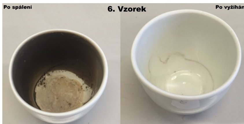
Obrázek 35: Vzorek č. 6 při stanovení popela - po spálení (vlevo) a po žihání (vpravo)
