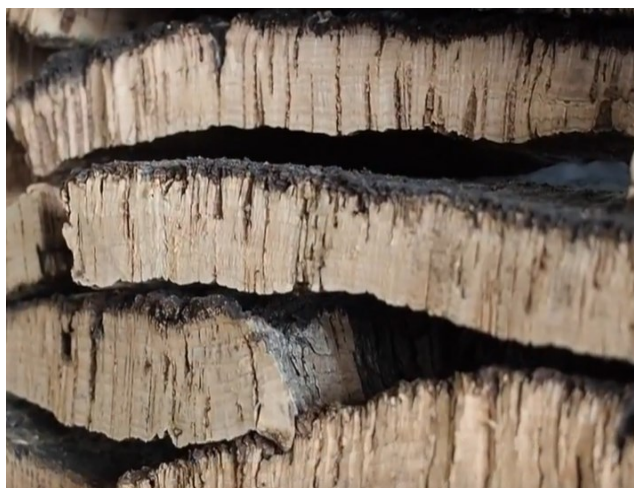
Obrázek 4: Uskladnění plátů po procesu vaření [9]
