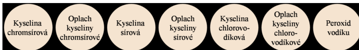
Obr. 17. Schématické znázornění postupu čištění laboratorního skla [48]
