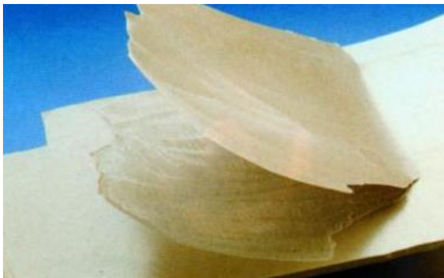
Obr. 15 – Delaminace povrchu výstřiku [19]
