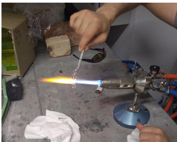
Obr.33 Tvarování skleněných baněk nad kahanem
