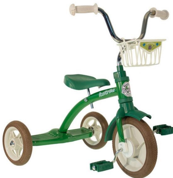
3. Obr. 16. Delta uspořádání je nejtypičtější
