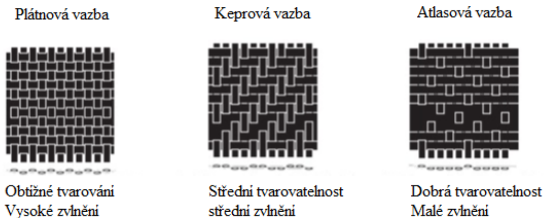
Obr. 41. Typy uspořádání vazeb vláken v kompozitních materiálech
