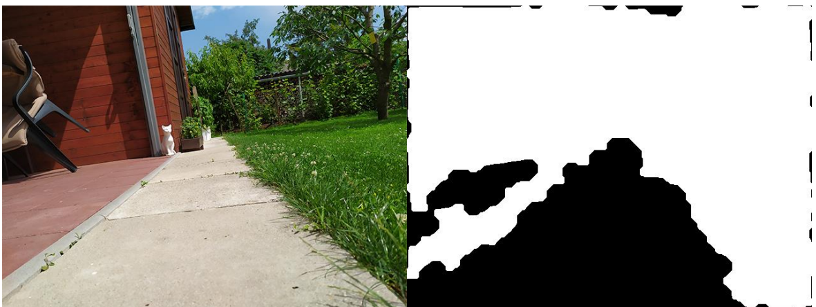
Obrázek 22: Porovnání originálního obrázku a obrázku s morfologickým uzavřením a následným otevřením
