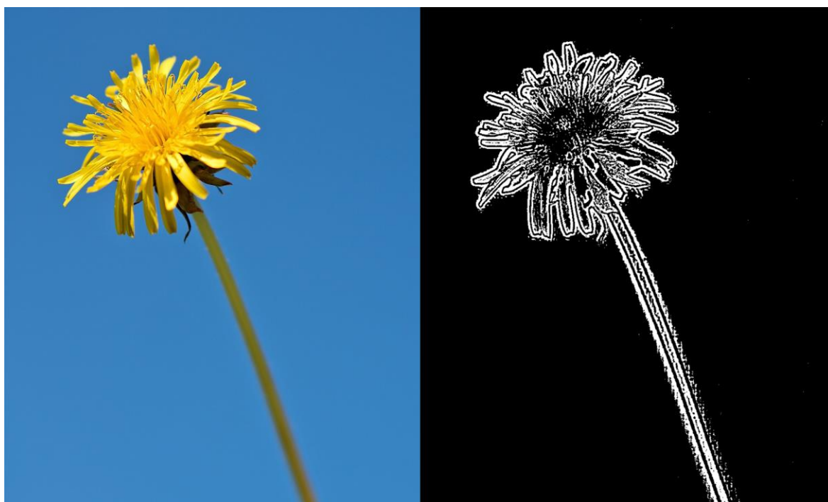
Obrázek 4: Porovnání originálního obrázku s obrázkem, na který je aplikována metoda prahování
