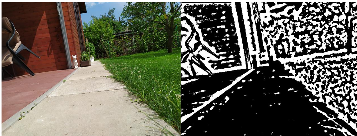
Obrázek 20: Porovnání originálního obrázku a upraveného pomocí diskretní dvourozměrné konvoluce s Gaussovým jádrem, převedeným do barevného prostoru HSV s následnou aplikací metody prahování
