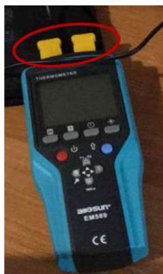
Obrázek č. 27. Digitální teploměr EM598 popis funkcí (Vlastní, 2021)
