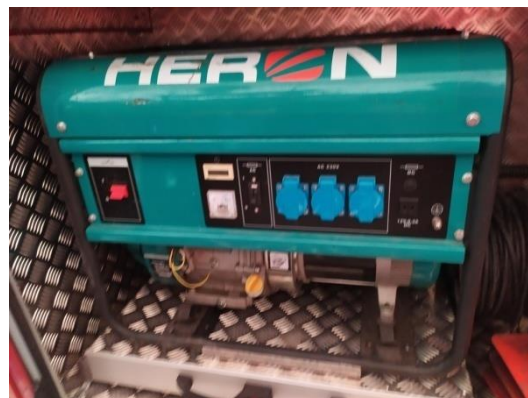
Obr. 20 Elektrocentrála HERON EGM 55 AVR-1 (vlastní)
