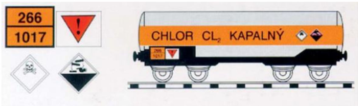
Obr. 5 Značení cisterny převážející chlor (Požární ochrana)
