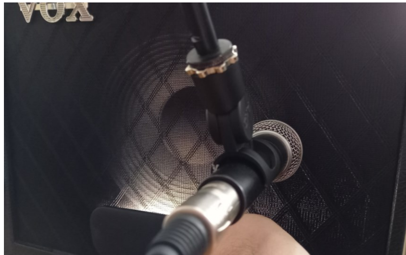
Obrázok 59. Poloha mikrofónu smerujúceho na kraj reproduktorového kužela
