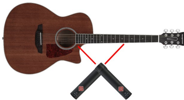
Obrázok 7. Stereofónna technika nahrávania XY
