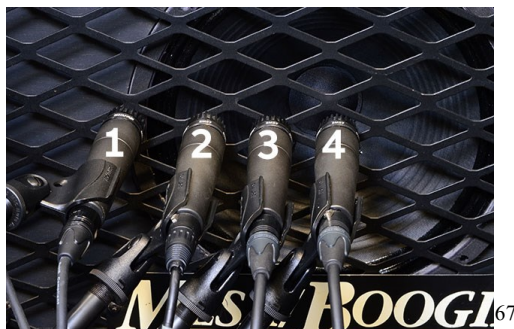
Obrázok 21. Štyri možné varianty umiestenia mikrofónu pri nahrávaní jedným mikrofónom v ose X
