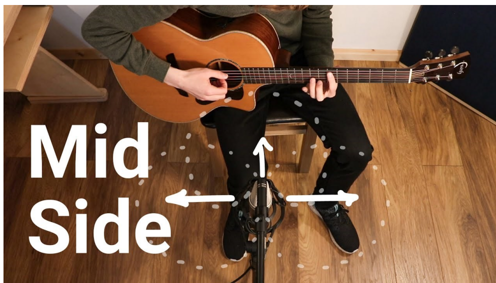
Obrázok 10. Stereofónna technika MS (Mid-side)
