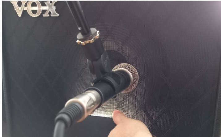
Obrázok 56. Poloha mikrofónu smerujúceho bližšie ku kraju reproduktorového kužeľa
