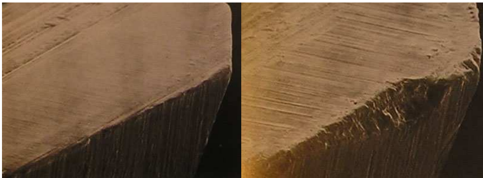
Obr. 24. Výlom plochy mm 2 vlevo ASP2030 67HRC, vpravo EM35 66HR [35].
