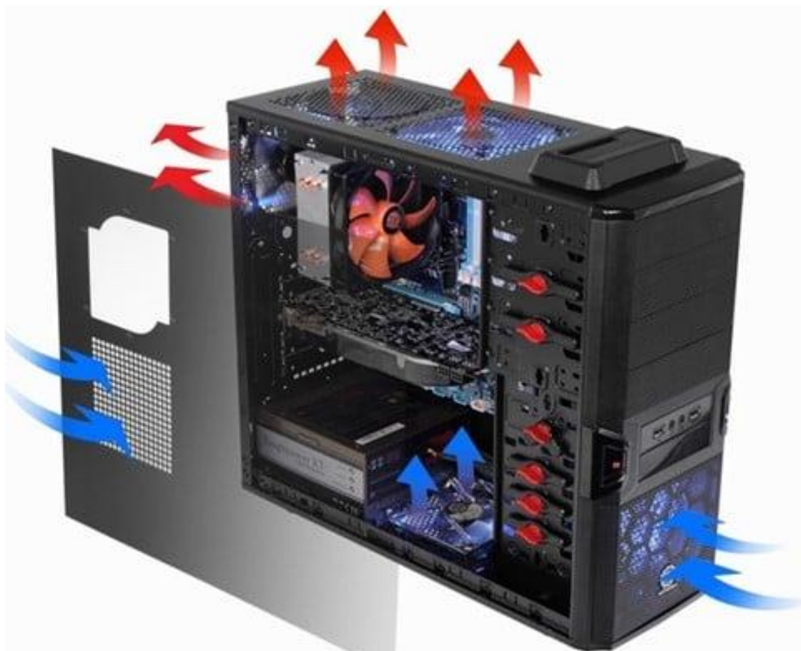
Obrázek 13 - Průchod vzduchu počítačem
