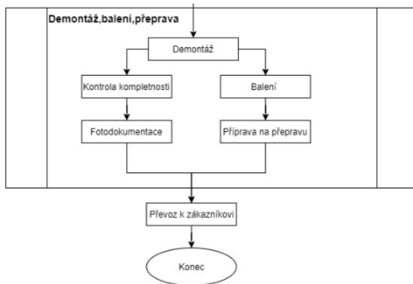
Obrázek 20 Část vývojového diagramu výrobního procesu – demontáž, balení, přeprava (zpracování vlastní)
