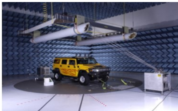
Obrázek 10 Sestava válcového dynamometru EMC a následné umístění
