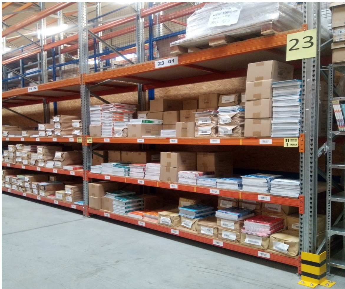
Obr. 12 Paletový regál dle dělení v sekci police
