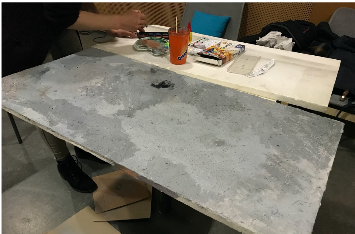
Obrázek 20 Výroba falešného zdrsňeného betonového stropu
