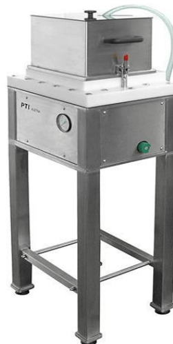
Obrázek 13 Příklad přístroje na měření nečistot (SSCA) (interní dokumentace)
