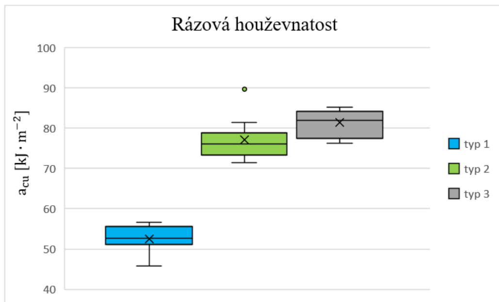
Obrázek 49 Vyhodnocení rázové houževnatosti
