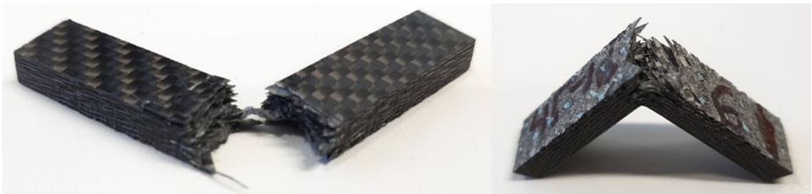
Obrázek 46 Typy porušení zkušebních tělísek u zkoušky rázové houževnatosti metodou Charpy
