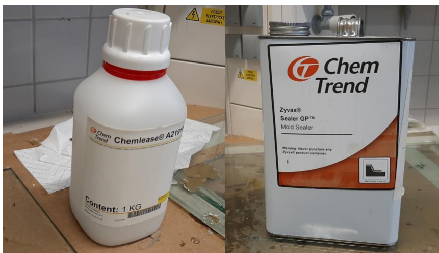
Obrázek 32 Separátor Chemlease 2191W (vlevo), plnič pórů Zywax Sealer GP™
