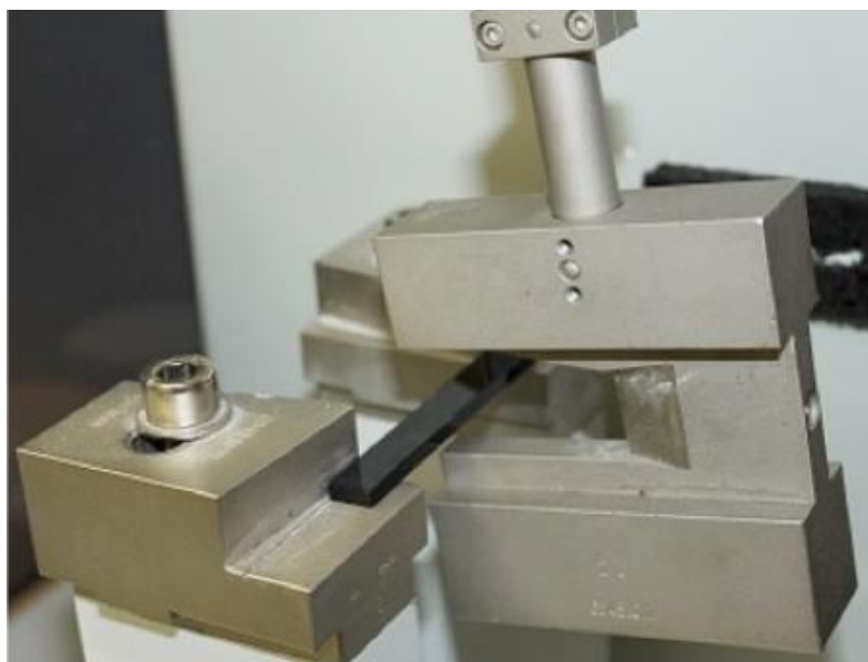
Obrázek 30 Zkouška rázem dle Charpyho [40]
