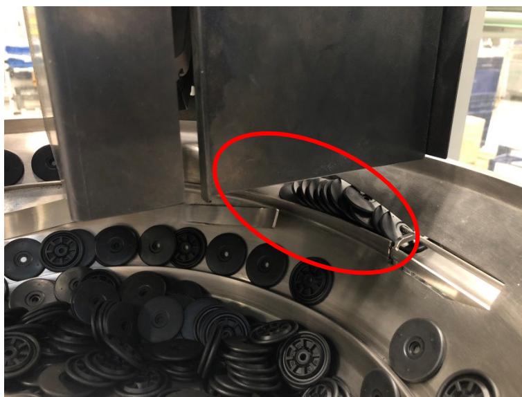
Obrázek 17 Stanice 1 – Zablokované Těsnící profily (vlastní foto)
