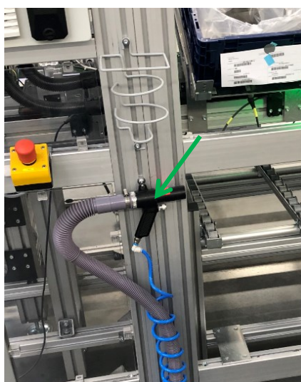
Obrázek 24 Stanice 2 – doplnění vysavače (vlastní foto)
