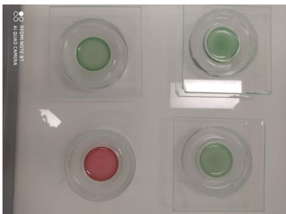
Obrázek 28: Vývoj vzorku při stanovení obsahu amoniaku
