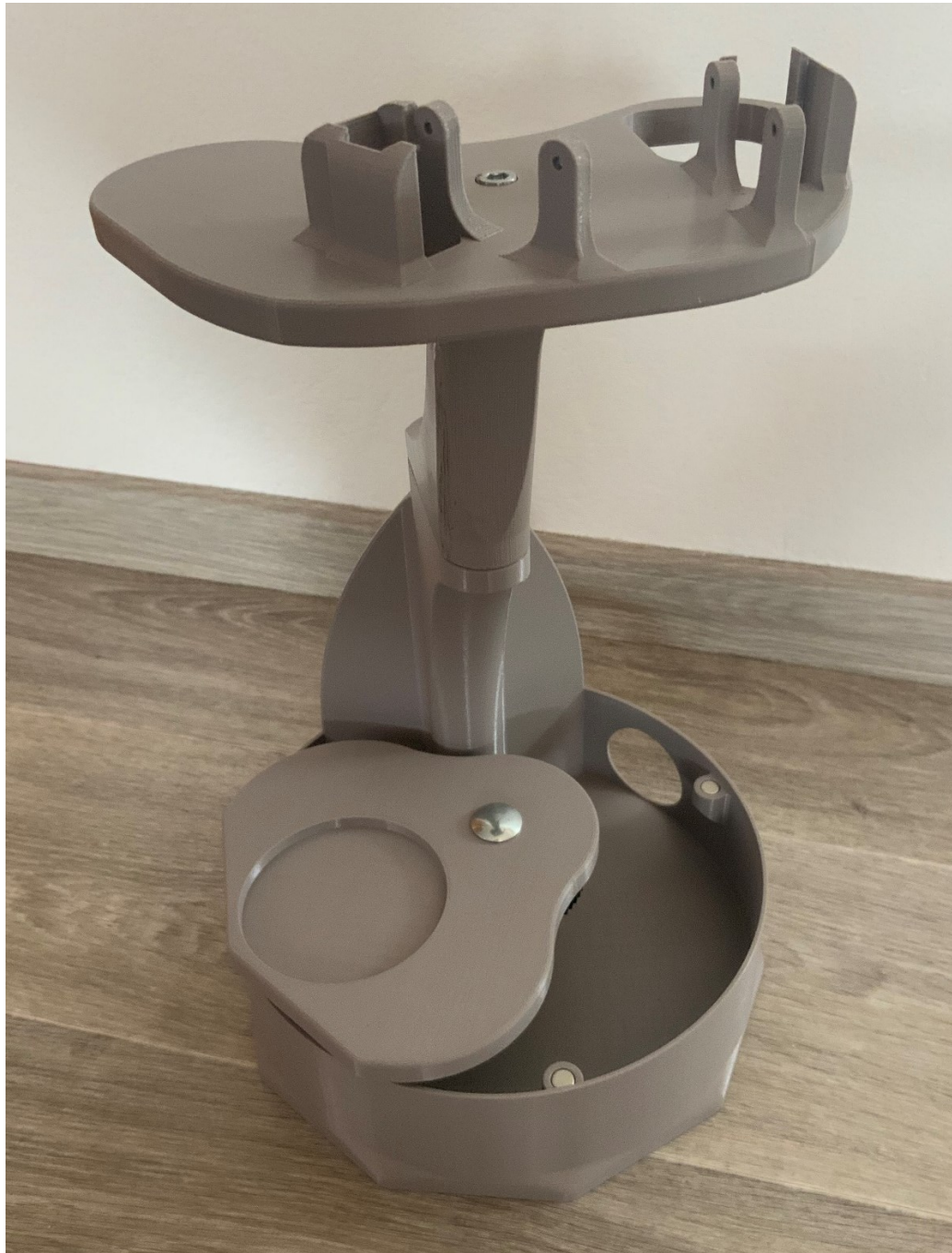
Obrázek 70: Konstrukce čajovaru vytištěná na 3D tiskárně
