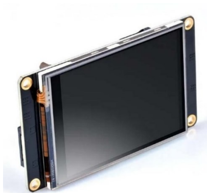
Obrázek 57: Displej Nextion orig. Enhanced NX3224K028 , 2.8" 320 x 240 [66]
