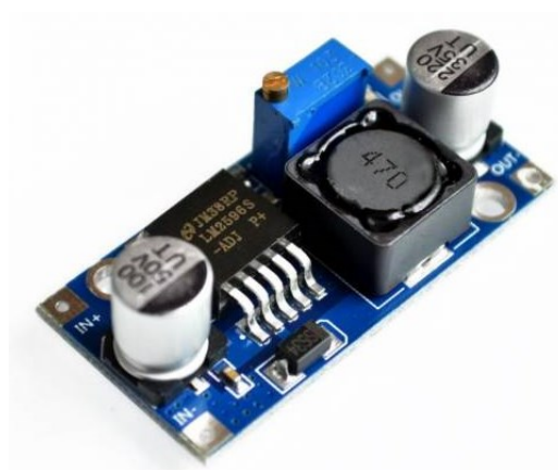
Obrázek 44: Ukázka step-down měniče s 92 % účinností přeměny [53]
