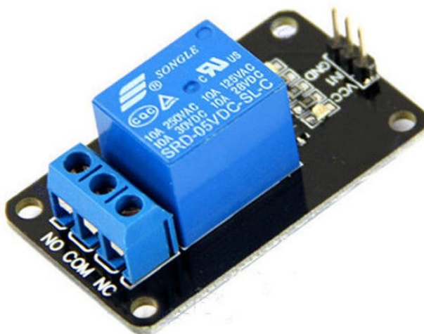
Obrázek 58: 1-kanálový relé modul [67]
