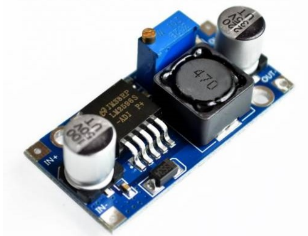
Obrázek 59: Step-down měnič – Stepdown nastavitelný měnič s LM2596 [68]
