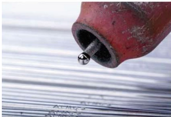
Obrázek 28: Kalota vytvořená na elektrodě [32]
