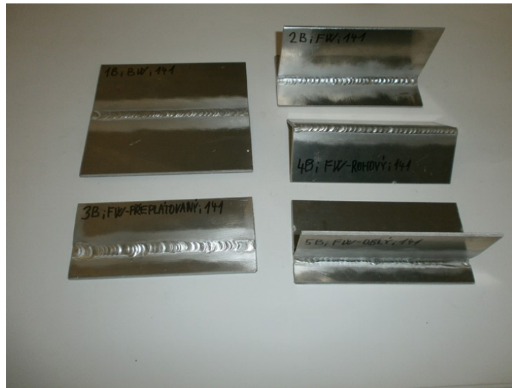
Obrázek 35: Zkušební vzorky svařené metodou TIG
