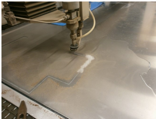
Obrázek 43: Dělení materiálu vodním paprskem
