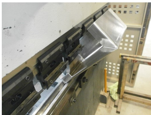
Obrázek 45: Ohýbání na ohraňovacím lisu
