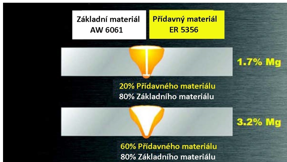
Obrázek 14: Vliv přípravy svarových ploch na zředění a chemické složení svarového kovu. [13]
