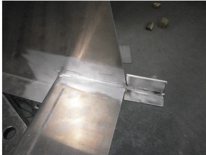
Obrázek 51: Vydrážkovaný kořen rohového spoje
