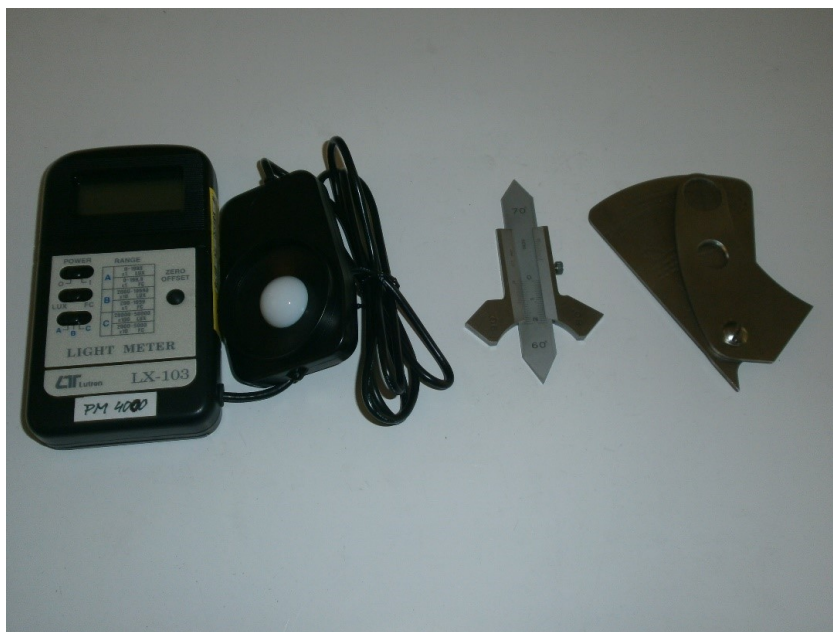
Obrázek 36: Luxmetr, měrka tupých svarů a měrka koutových svarů použité při vizuální kontrole
