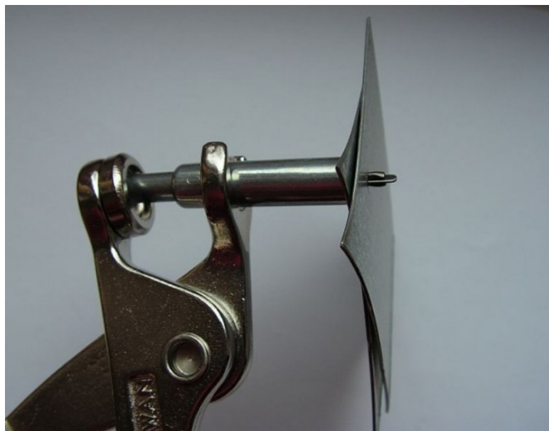
Obr. 22: Zajištění plechů pomocí Cleco svorky [29]
