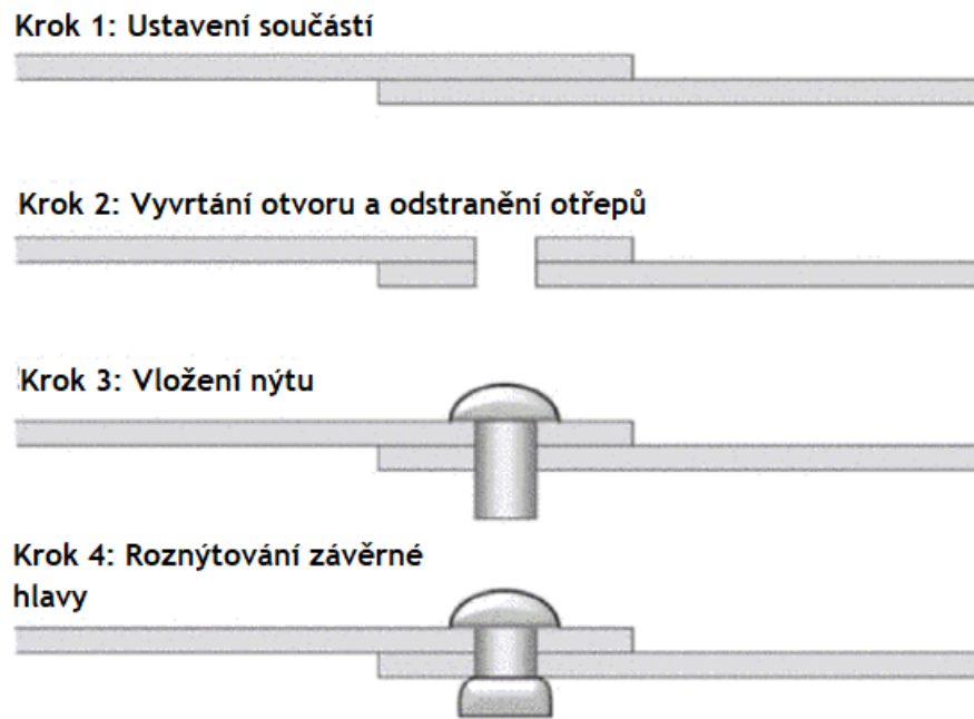
Obr. 21: Standardní postup zhotovení nýtového spoje [6]
