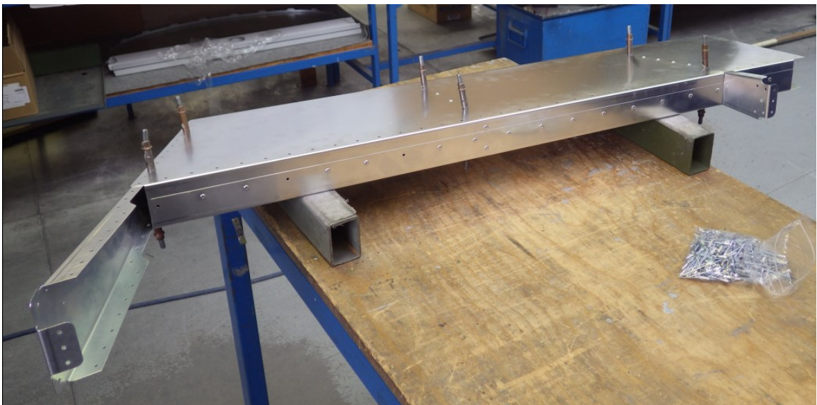
Obr. 46: Zajištění zadního potahu se žebry pomocí leteckých agraf a jejich nýtování
