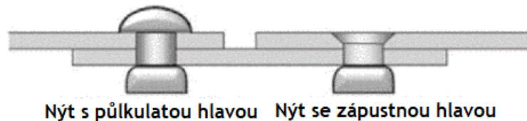
Obr. 20: Dva nejpoužívanější typy nýtů v letectví [6]
