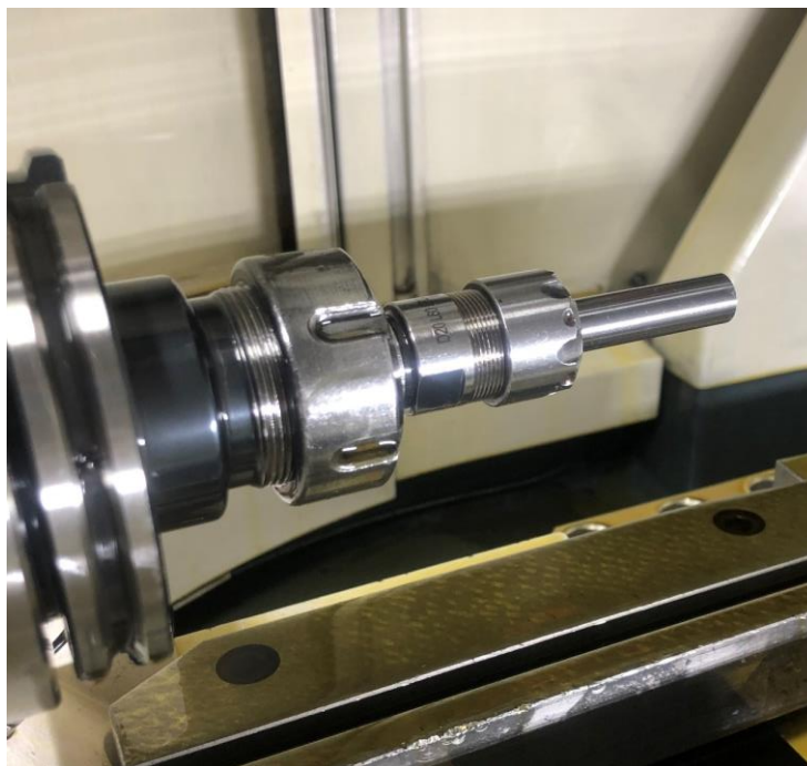
Obrázek 19 Polotovár v kleštinovém upínací s prodloužením
