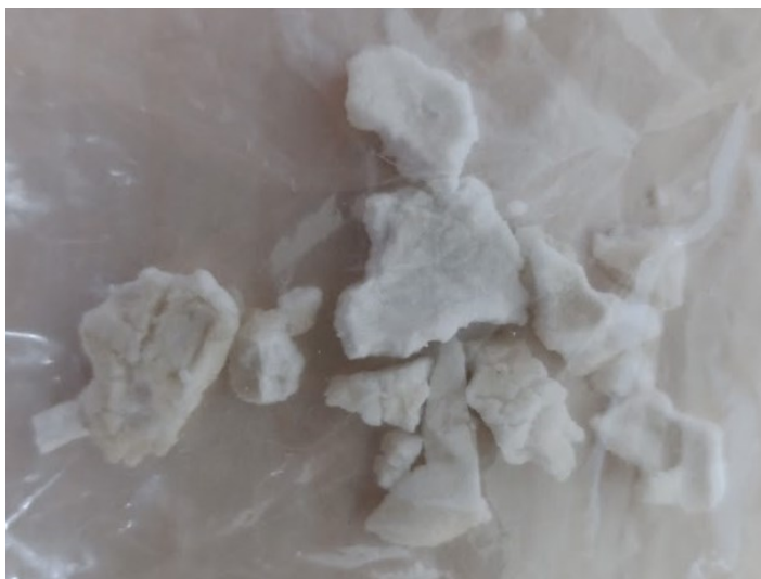
Obr 43 – ZEO10 po vypěnění, výrazné drolení vzorku
