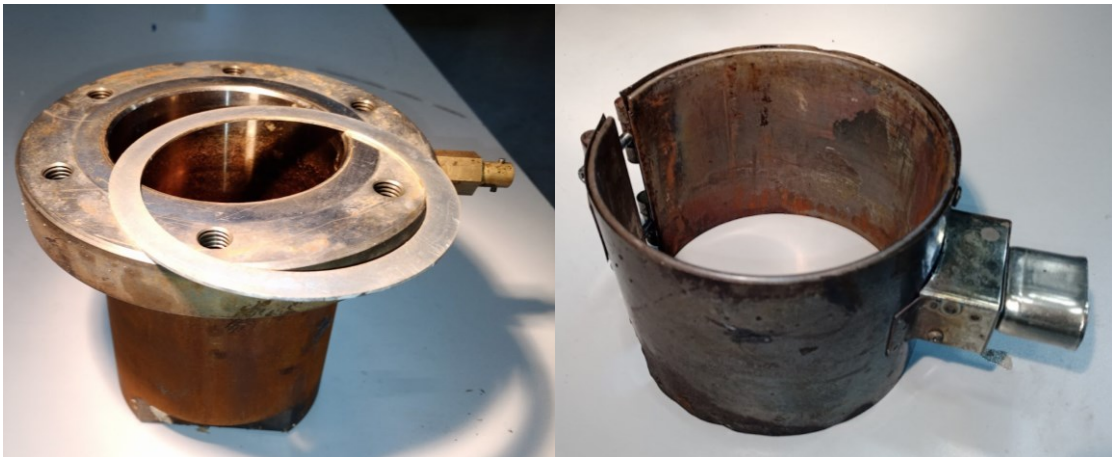
Obr 31 – Tlaková komůrka (tělo a těsnění – vlevo, topný pás – vpravo)
