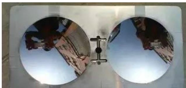
Obrázek 24: Leštěná dutina vstřikovací formy [24]
