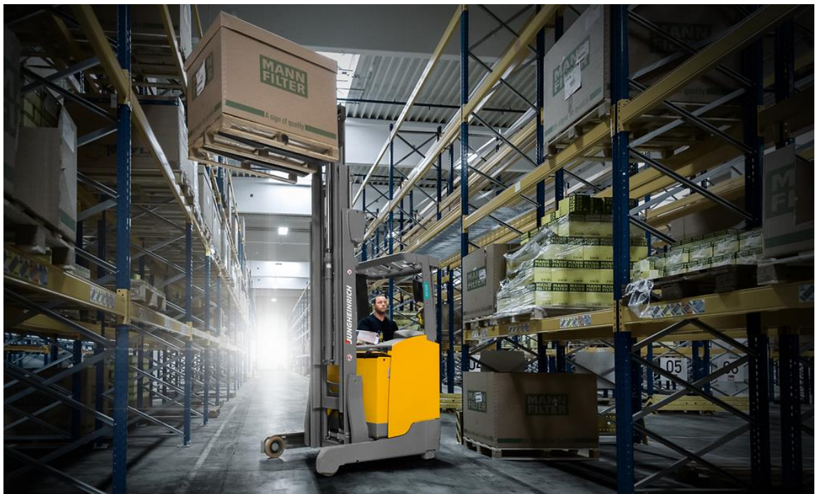
Obrázek 36 Manipulační technika – retrak vozík (zdroj Jungheinrich)
