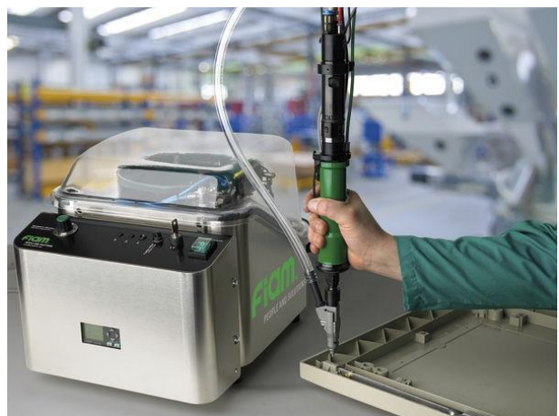
Obrázek 37 Automatický podavač šroubů (zdroj alfavaria)
