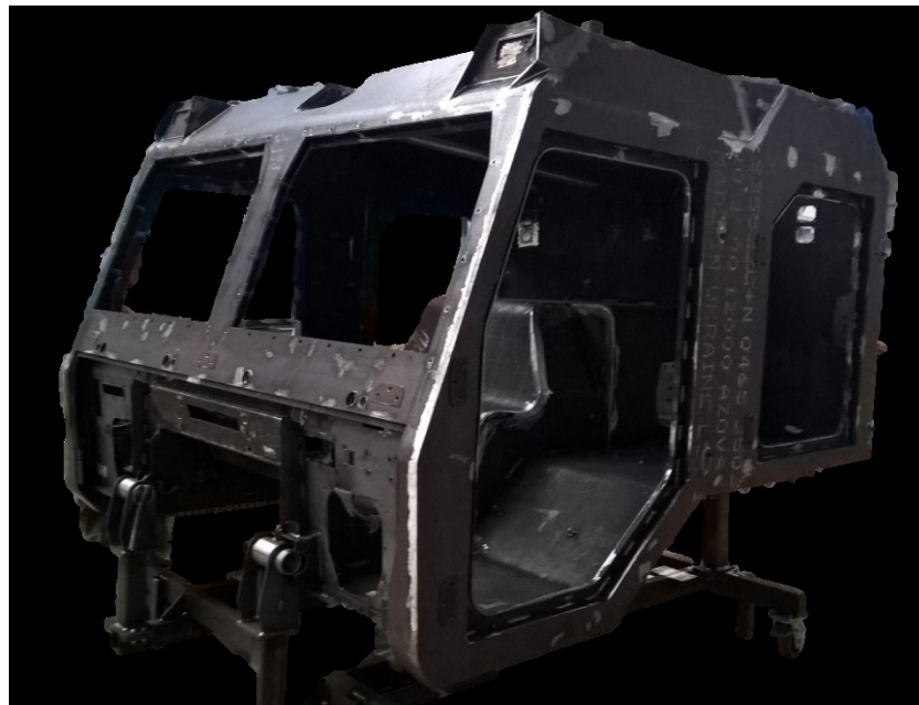
Obrázek 11 – Svařenec kabiny T 815
