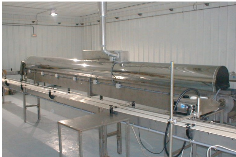
Obrázek 12: Tunel využívající ozon a UV záření. [100]
