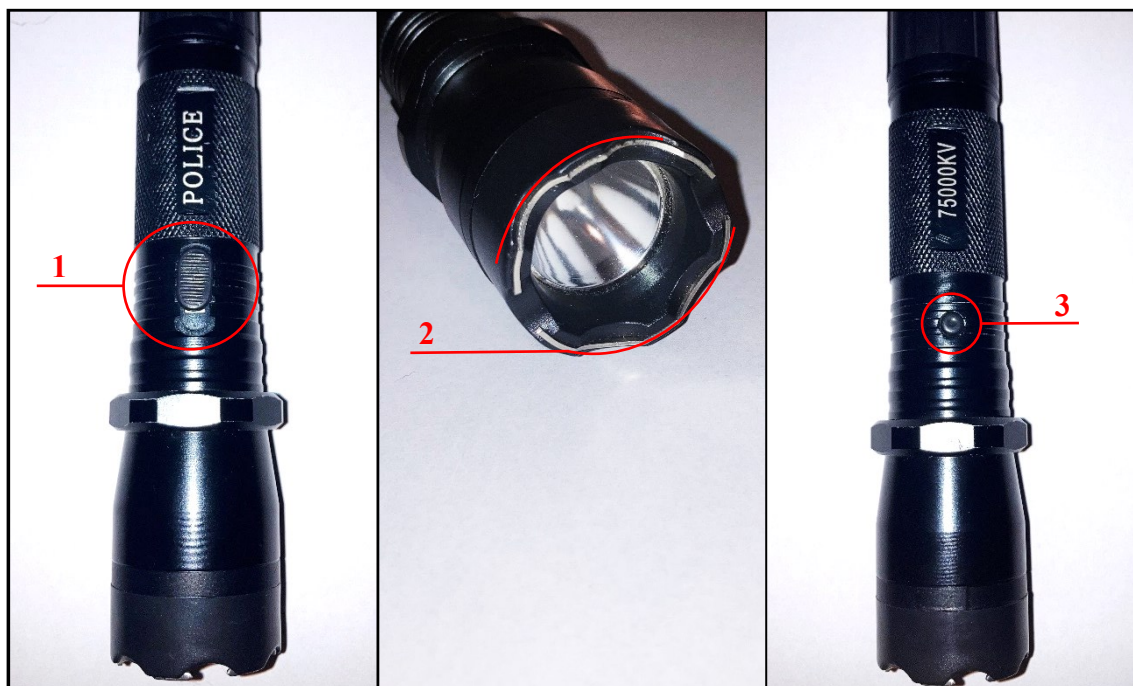
Obrázek 6. Taktická svítilna s elektrickým paralyzérem [vlastní]
