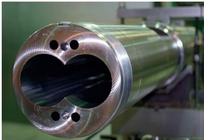
Obr. 33.: Ukázka válce pro dvoušnekový extruder [2]
