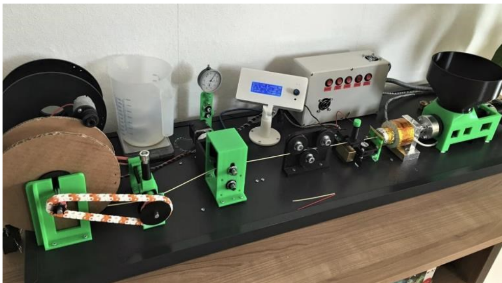
Obr. 1.: Ukázka vytlačovacího stroje na polymerní strunu [7]
