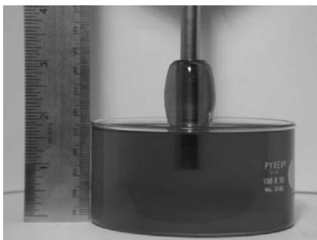
Obr. 20.: Experimentální pokus Weissenbergova efektu [15]
