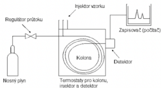
Obrázek 11 Schéma inverzní plynové chromatografie [7]
