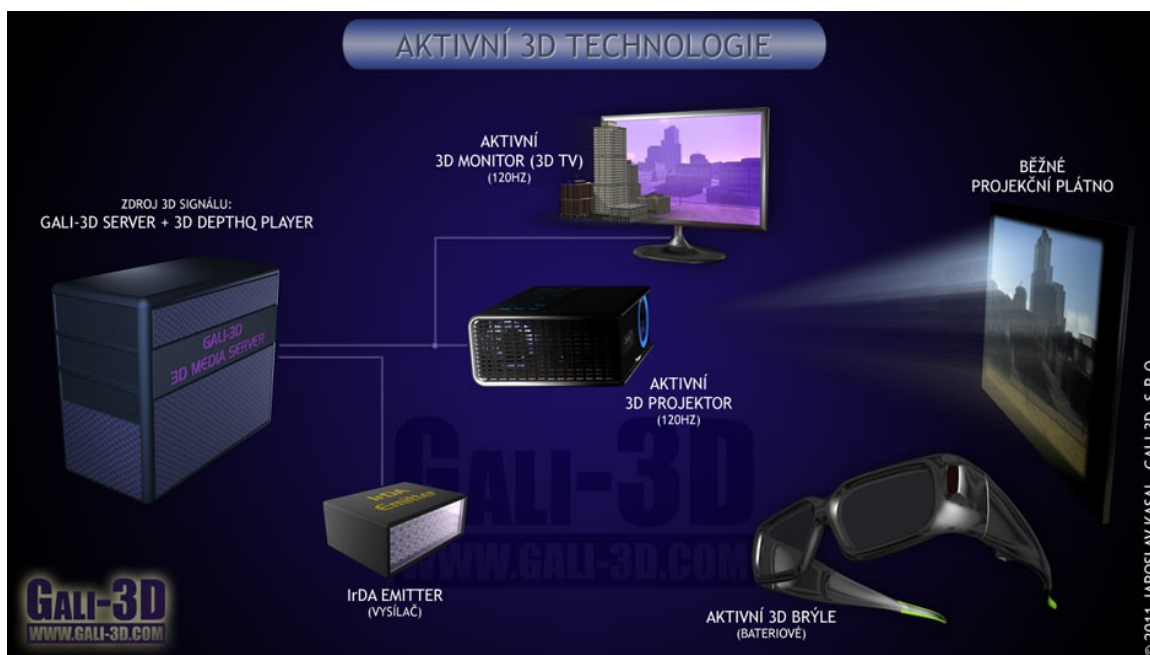
Obrázek 42 aktivní 3d stereoskopická technologie- (Aktivní 3D stereoskopická technologie, ©2005-2011)
