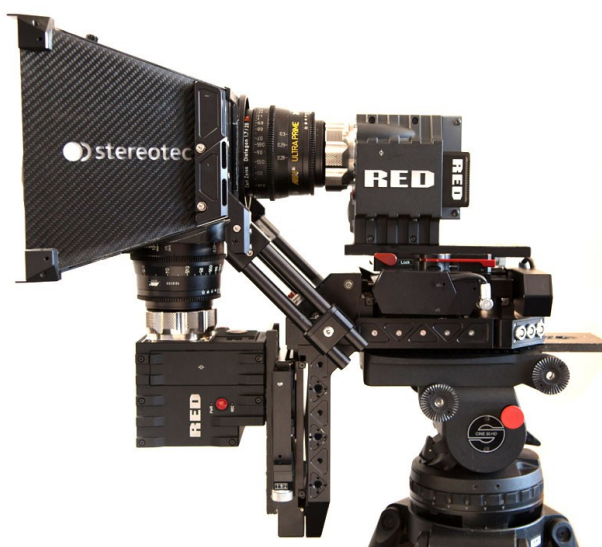
Obrázek 41 Light weight RIG - příklad kamery pro natáčení 3D materiálu. (LIGHT WEIGHT RIG)
