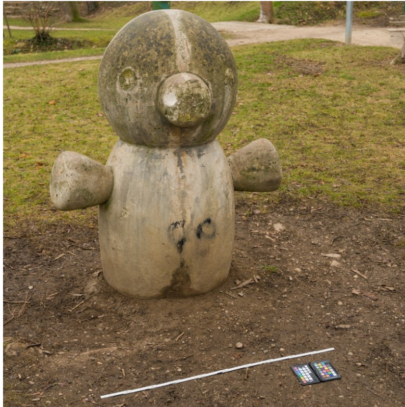
Obr. 8.1 Socha připravená na snímání s umístěnou barevnou tabulkou a metrem pro referenci rozměrů.
