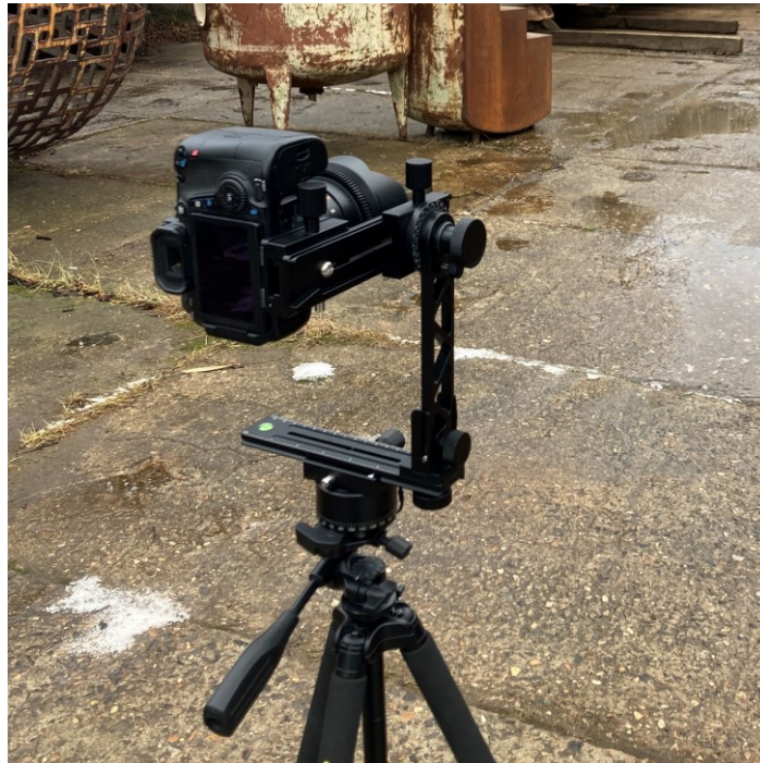
Obr. 3.3 Fotoaparát na stativu s uzlovým bodem.
