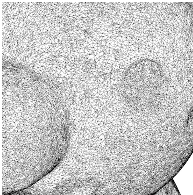
Obr. 8.4 Geometrie objektu vytvořeného pomocí fotogrammetrie, již zmenšená na 500 000 vertices.
