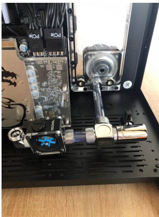
Obrázek 43. Propojení výměníku s roztojkou – foto autora
