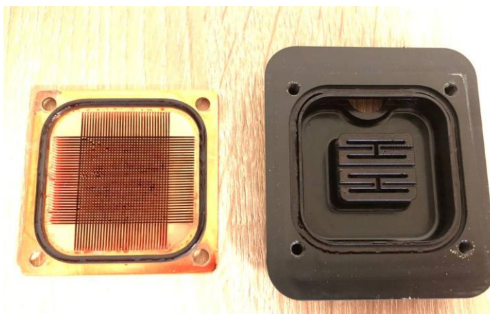
Obrázek 31. Vnitřní pohled na chladicí blok pro procesor – foto autora
