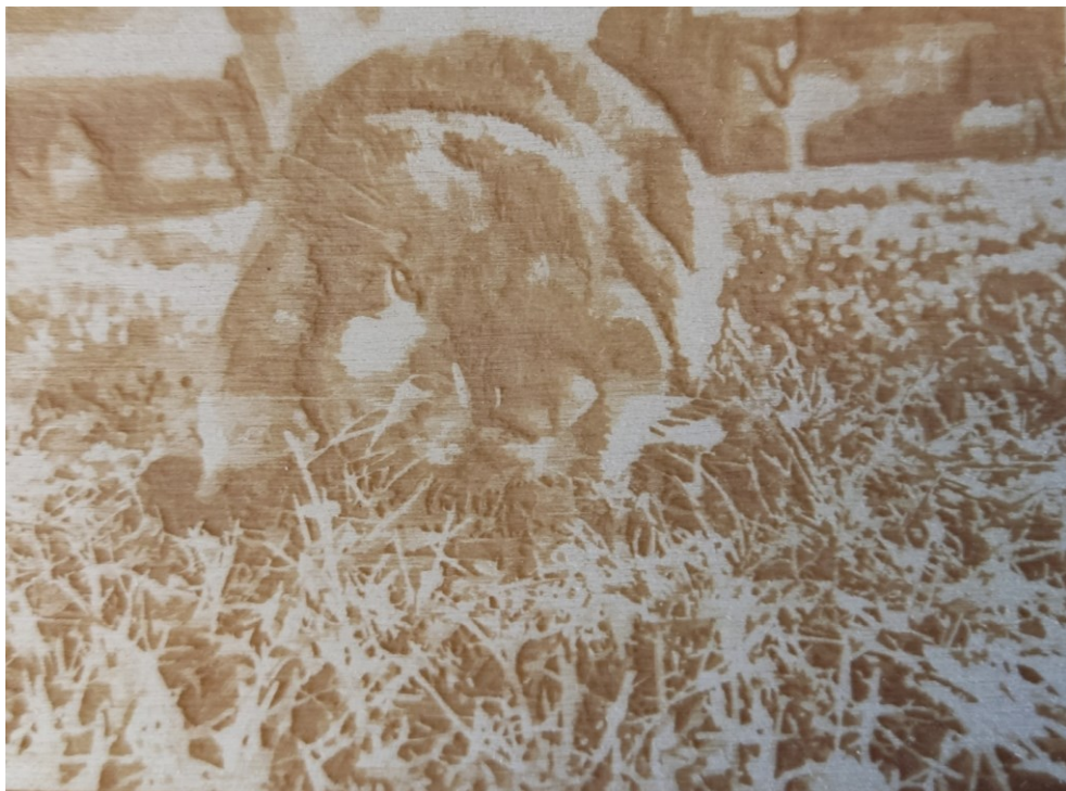
Obrázek 55 Výsledná gravura pomocí odstínů šedé – vzorek 2
