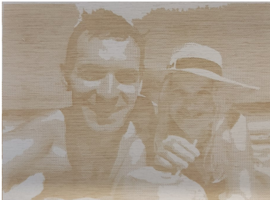
Obrázek 61 Výsledná gravura pomocí odstínů šedé – vzorek 6
