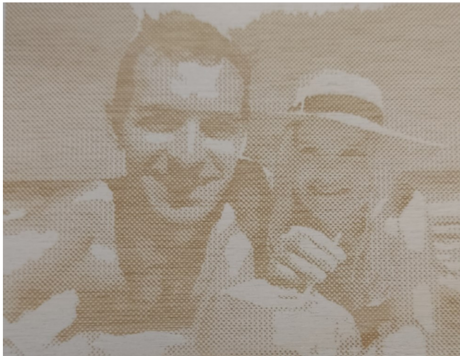
Obrázek 63 Výsledná gravura pomocí odstínů šedé – vzorek 7
