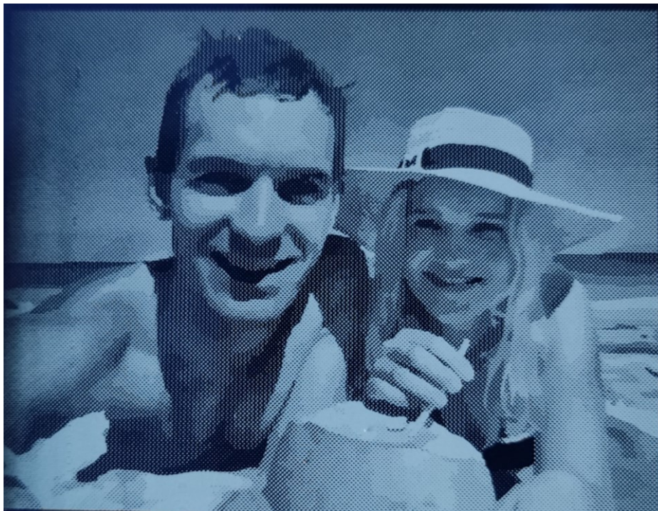
Obrázek 70 Výsledná gravura pomocí odstínů šedé – vzorek 12
