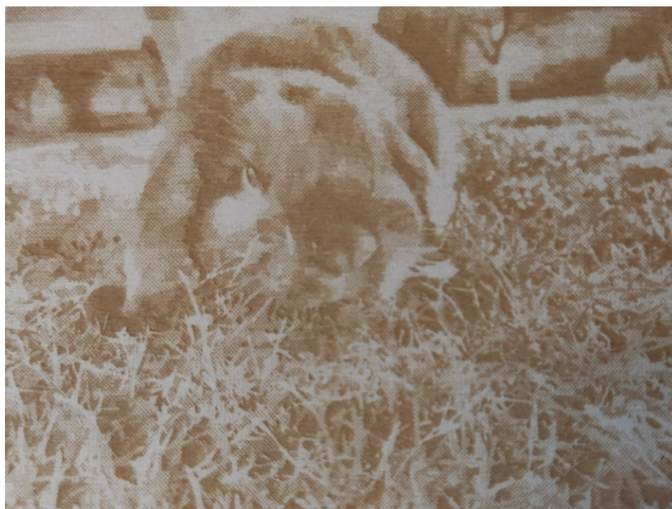
Obrázek 56 Výsledná gravura pomocí odstínů šedé – vzorek 3
