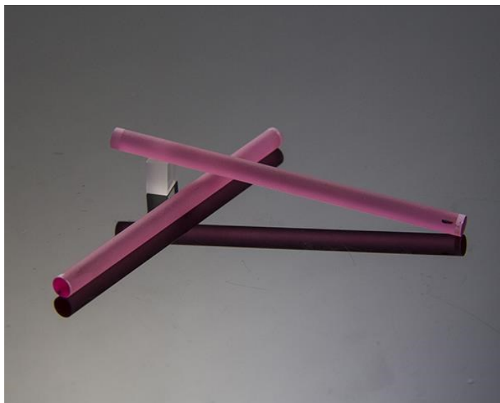
Obrázek 3 Aktivní prostředí – Erbiem dopovaný Yttrium hlinitý granát (Er: YAG) [8]
