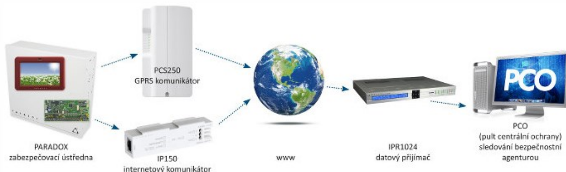
Obrázek 1. Schéma řešení přenosu dat na DPPC [3]
