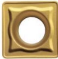
Obr. 27 Cermetová destička SCGX050204-P2 T250D [42]
