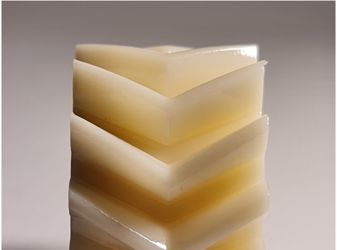
Obr. 38: Povrch planetárneho kolesa po 60 sekundách pieskovania a 15 sekundách leptania
