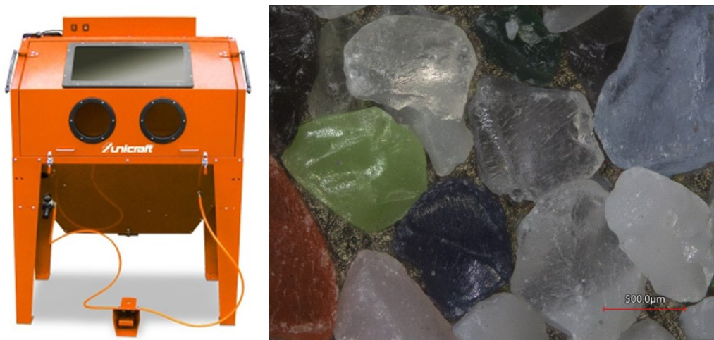
Obr. 35: Pieskový box Unicraft SSK3 (naľavo) a abrazivo Maxi-Blast CK2 (napravo)
