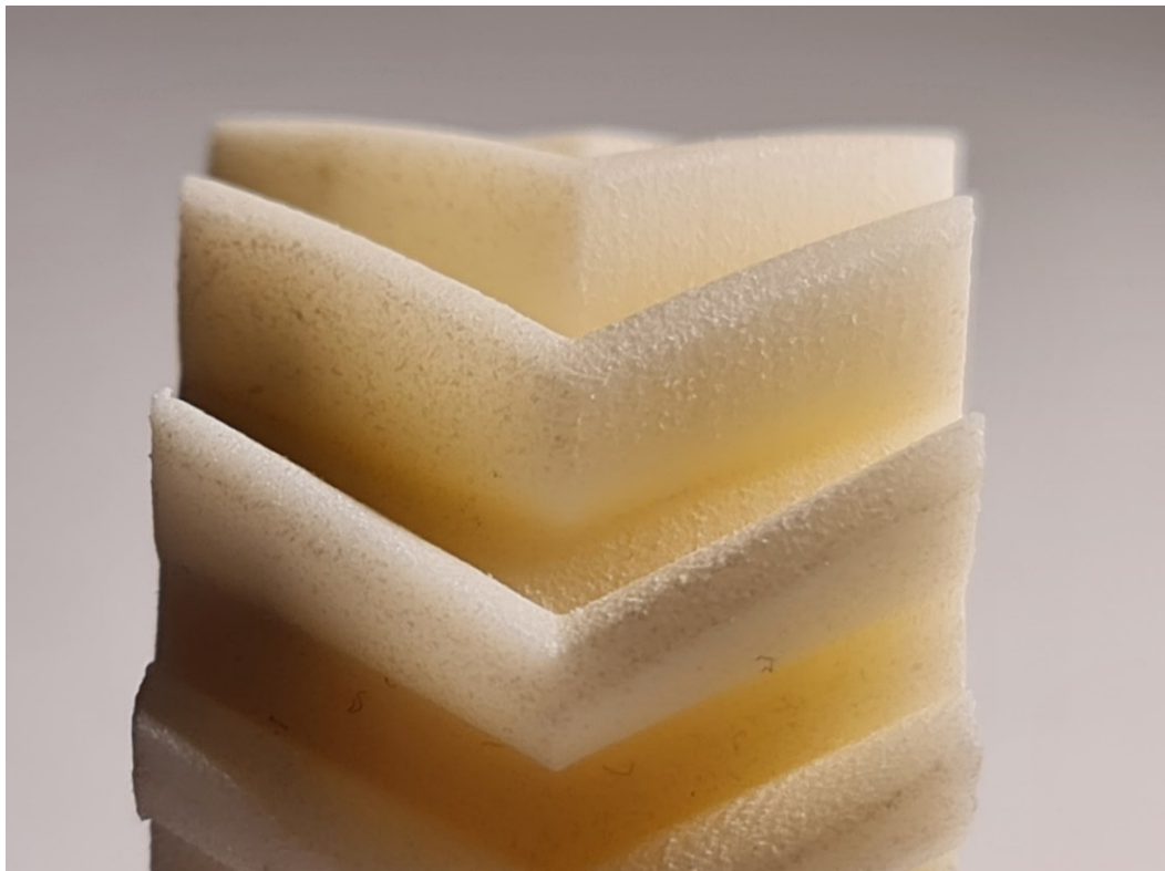
Obr. 36: Povrch planetárneho kola po 60 sekundách pieskovania
