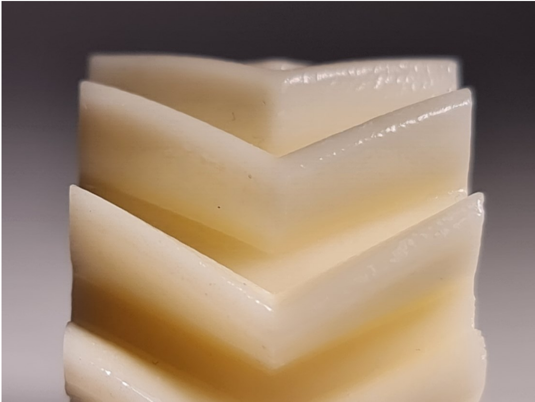
Obr. 44: Opotrebená vzorka leptaného planetárneho ozubeného koleša
