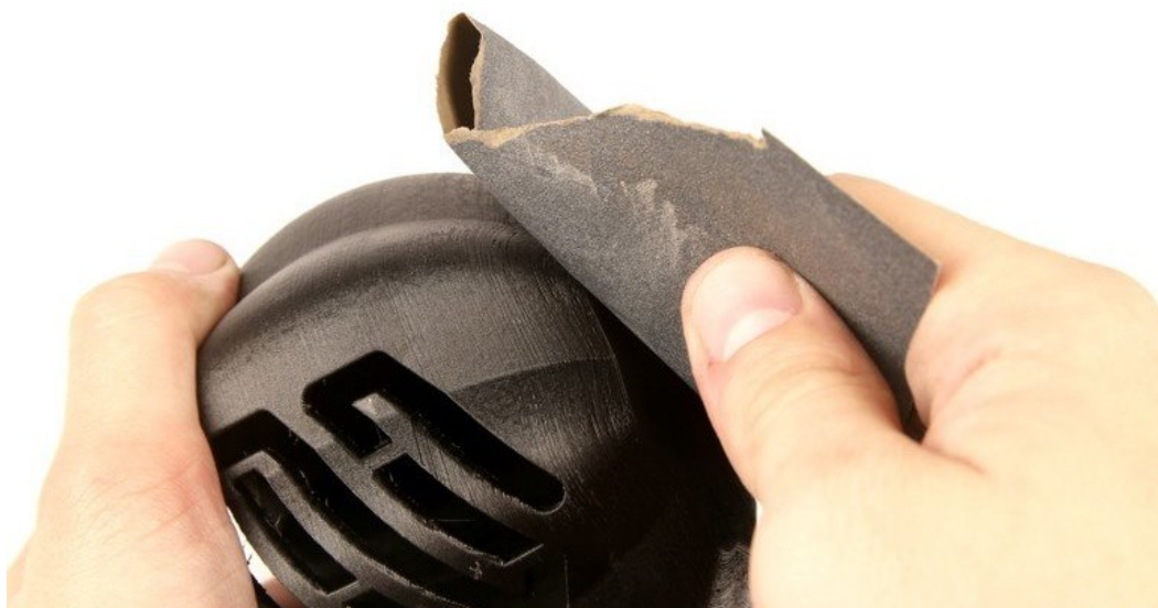
Obr. 16: Obrusovanie výrobku brúsnyim papierom [24]
