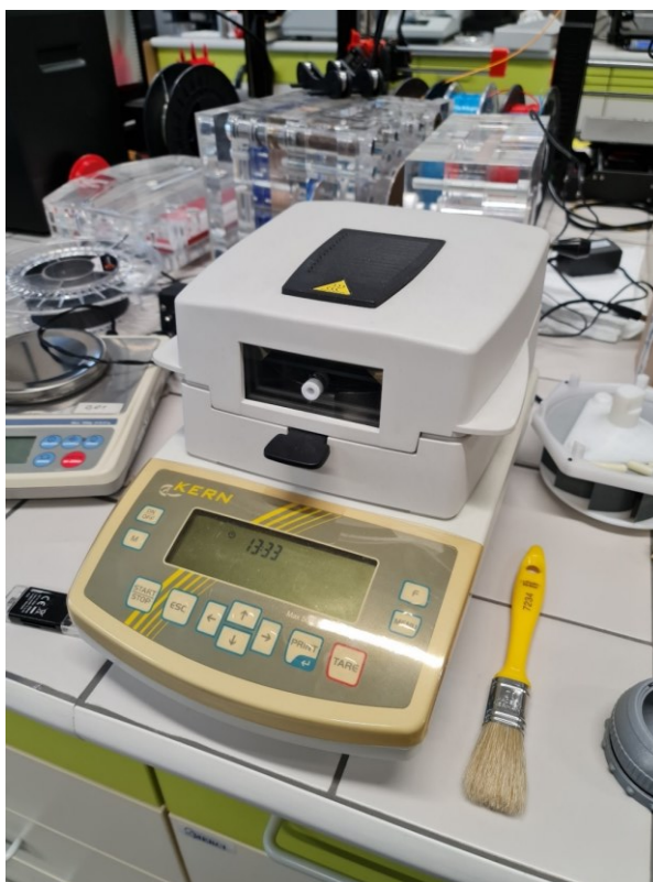
Obr. 39: Laboratórne váhy KERN použité na meranie stratenej hmotnosti
