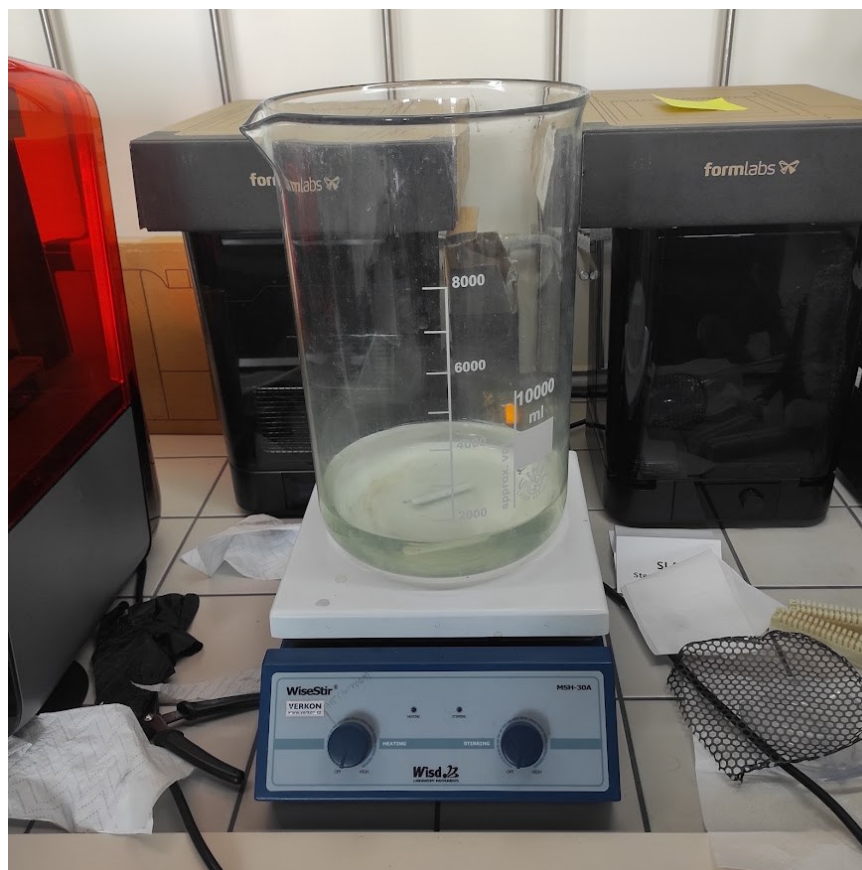
Obr. 37: Sklenená nádoba na leptanie
