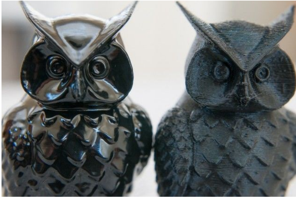
Obr. 18: Výrobok pred (pravá strana) a po (ľavá strana) vyhladení acetónovými parami [29]
