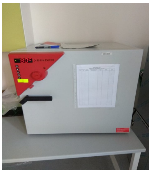
Obr. 26: Sušárna Binder FD 53 použitá pro stanovení tepelné stability
