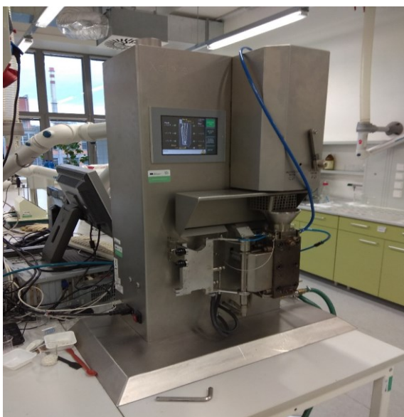
Obr. 22: Laboratorní dvoušnekový mikrohnětič DSM Xplore
